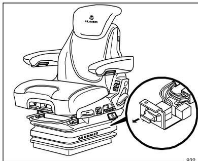
Nel caso che una componente elettrica sia difettosa deve prima essere controllata la protezione interna.
