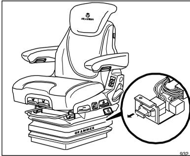
Si se produce un fallo en el suministro de corriente, primeramente se deben controlar los fusibles internos.
