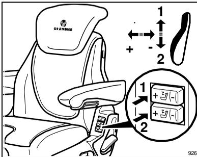
Azionando l'interruttore superiore e inferiore il grado di bombatura nella parte superiore e inferiore dell'imbottitura dello schienale può essere adattato in modo individuale.
