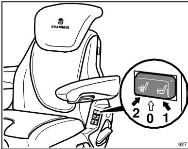
La climatizzazione attiva del sedile fa sì che la superficie del sedile rimane sempre asciutta. L'umidità del corpo nella zona di contatto con il sedile viene rimossa. In questo modo il conducente sta sempre seduto fresco e asciutto.
